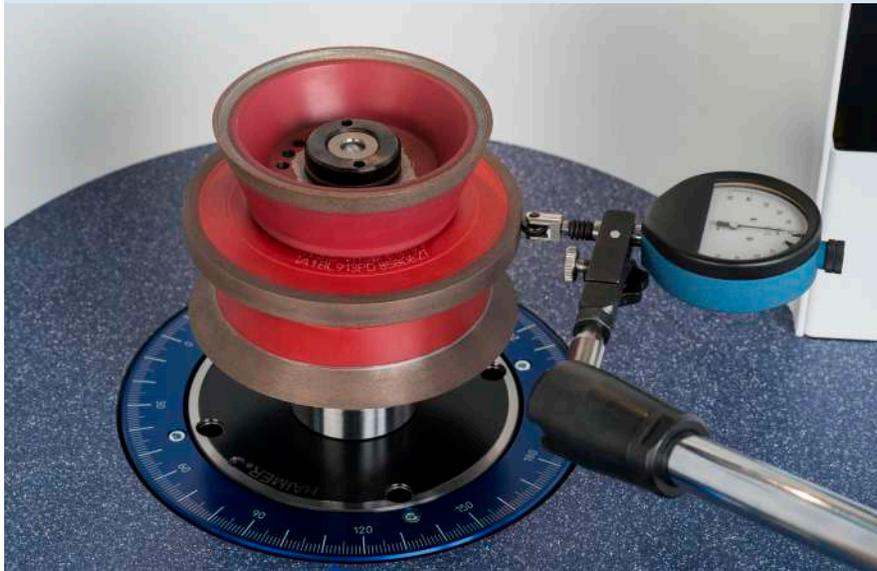
Medición del runout
