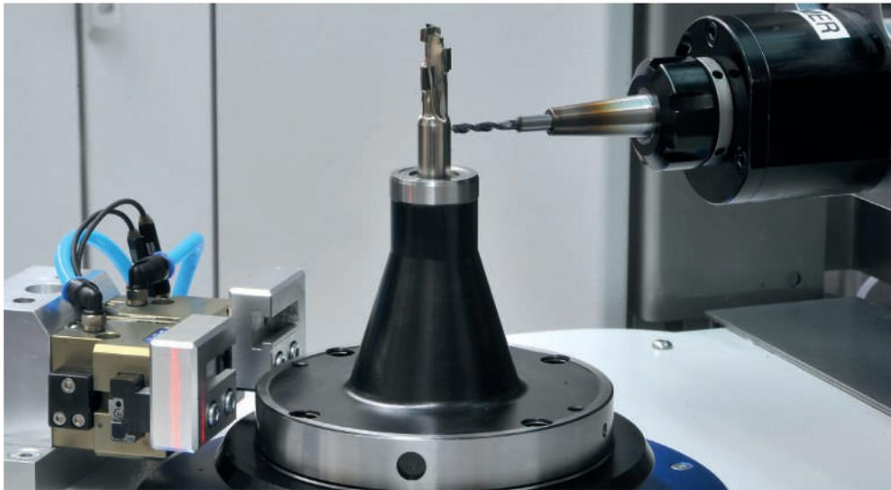
**Balaneo de herramientas con un adaptador de balanceo HG para herramientas con zanco cilíndrico**
