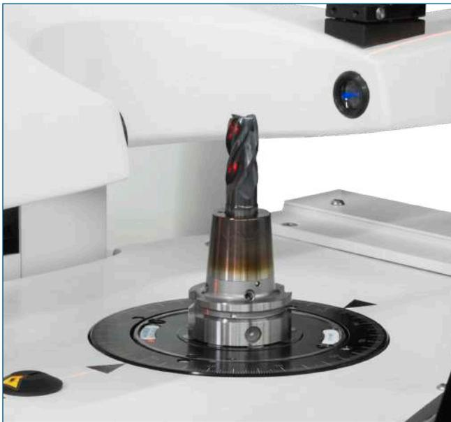
Medición sin contacto con una cámara de alta resolución y procesamiento digital de imágenes, incluye software de medición "Microvision"
