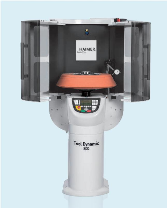
La cubierta de seguridad está segmentada y se abre hacia los lados. Así, el rotor es accesible desde arriba, las piezas pesadas pueden ser manejadas por una grúa.
