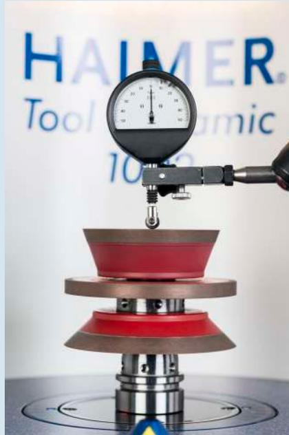
Con el dispositivo para medir runout usted puede hacer una comprobación fácil y confiable del runout del disco abrasivo y del runout axial. La unidad de medición de la concentricidad consiste en: Brazo de medición e indicador de carátula con una precisión de 0.001 mm, así como un rodillo de medición.
