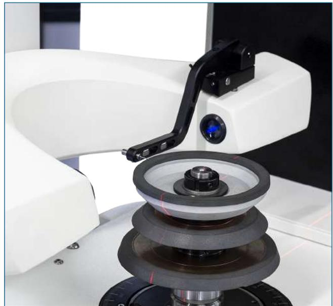
**Opcional: Dispositivo de medición para ruedas abrasivas para el enfoque sencillo y fácil medición de ruedas abrasivas**
