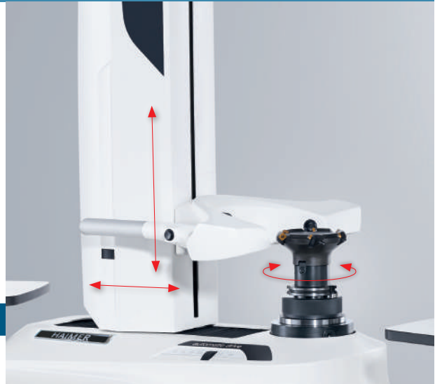
Preseteo y medición de herramientas completamente automático, independiente del operador
